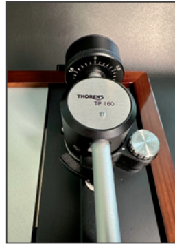
Fig. 8 Lagerblock, installiertes Gegengewicht mit Skala für die Auflagekraft und Antiskatingeinstellung.
