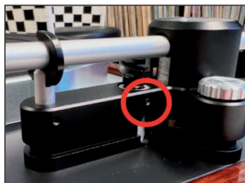
Ill. 15 Réglage en hauteur du lève-bras
