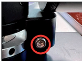
Ill. 11 Verrouillage de base sur le bras de lecture.
